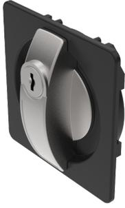
Loquet carré pour montage par clipsage et loquets à tige avec fixation rapide de la tige. La rotation de la came est de 90° dans le sens des aiguilles d'une montre ou dans le sens inverse. Montage universel à droite et à gauche dans une épaisseur de porte de 0,8 - 1,0 mm. Le cylindre dispose de 1000 combinaisons-clés.
