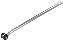
Varões redondos de  $\varnothing 8\text{mm}$  com roletes de  $\varnothing 15\text{mm}$  para linguetas multi-ponto. O modelo R-L tem um olhal estampado na extremidade. O comprimento L no desenho é a medida total do centro do olhal até o fim do rolete.
