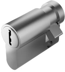
40 毫米黄铜型材锁芯，可 360° 旋转。该锁芯按照 DIN 18252 标准制造，具有五个销。该锁芯随附三把钥匙和固定螺钉，凸轮可进行 8x45° 定位。实心插门需插入形如锁芯的孔内，如果不需要锁芯，可以使用随附的螺钉将插门固定到把手的锁芯孔内。插门采用弹簧加压来实现按压上锁功能。
