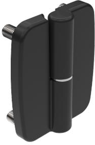
带固定 M8 螺栓的外部升降铰链。提供左开和右开铰链门版本。图示为适合左开铰链门的版本。开启角度 180°。铰链不随附提供螺母或垫圈，但可单独订购（参见本页“相关产品配件”项下的零部件号）。
