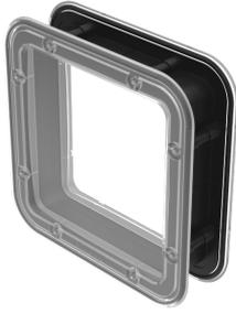
Janela de inspeção quadrada em policarbonato transparente e resistente a impacto. Adequado para aplicações de HVAC em portas com isolamento Térmico ou duplas. A janela está equipada com uma junta integrada e é adequado para unidades com pressão positiva ou negativa. A montagem usa oito parafusos de aço inoxidável auto-atarraxante de um lado só.
