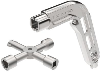
Trois clés multiples différentes : dessin du haut : clé multiple avec quatre prises de clé : triangulaire 8, carrée 6, carrée 8 et DIN 5. L'ouverture hexagonale au centre de la clé sert de porte-embout pour un embout standard de type tournevis. Dessin du bas : les clés multiples avec deux prises de clé sont disponibles en deux versions différentes : version A) DIN 5 et hexagone 10 (illustré). Version B) DIN 5 et Deutsche Bahn (aussi appelé DB).
