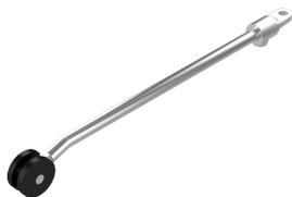
直径 8 毫米的圆杆，带有 25 毫米滚子，适用于带多点凸轮的把手和门锁。图中的长度 L 是从平头孔眼中心到滚子末端的总长度。R 型杆搭配杆连接器（需单独订购）使用。连接器使总长度增加 14 毫米（见图）。本产品以定制长度交付，仅应要求提供。
