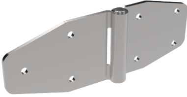
重型翻转铰链，使用螺钉或铆钉安装。非常适合车辆应用。铰链叶片可折叠，适合平面安装。开启角度 180°。铰链销已固定。
