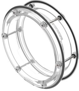
透明、耐冲击聚碳酸酯制成的圆形观察孔。适用于使用隔热门或双层门的暖通空调应用。观察孔装有集成垫圈，适用于正压或负压装置。观察孔分成两半交付，可组装在带有 182 毫米直径孔的门内。使用随附的螺栓和螺母即可轻松固定。安装孔所在圆形区域的直径为 195 毫米。
