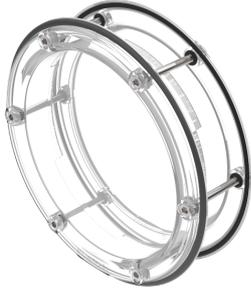
Janela de inspeção circular em policarbonato transparente e resistente a impacto. Adequado para aplicações de HVAC em portas com isolamento Térmico ou duplas. A janela está equipada com uma junta integrada e é adequado para unidades com pressão positiva ou negativa. A janela é composta de duas metades alojadas em um recorte de circular de 182mm. A montagem é simples usando parafusos e porcas fornecidos.
