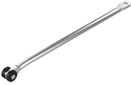
Tige ronde  $\varnothing 8$  mm avec galet de 15 mm, pour poignées et verrous à cames multipoints. La tige modèle R-L a une extrémité estampée et plate avec un œil. La longueur L indiquée sur le dessin est la longueur totale entre le centre de l'œil et l'extrémité du galet.
