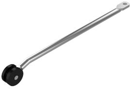
Varões redondos de  $\varnothing 8\text{mm}$  com roletes de  $\varnothing 25\text{mm}$  para linguetas multi-ponto. O modelo R-L tem um olhal estampado na extremidade. O comprimento L no desenho é a medida total do centro do olhal até o fim do rolete.
