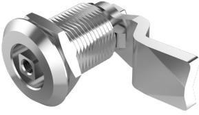
Le loquet quart de tour se compose d'un boîtier, écrou, insert, d'une rondelle, vis et came, au choix. Un boîtier plus long peut être utilisé pour portes isolées. Le boîtier de 45,5 mm peut être monté avec un clip à ressort pour des épaisseurs de porte de 29, 32 ou 39 mm et le boîtier de 56,5 mm pour 40, 43 et 50 mm.
