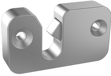
O capturador retém o varão dentro da lingueta móvel. A lingueta do capturador só retrai para receber o varão. Para abertura o varão deve ser recolhido de dentro do capturador. O capturador recebe o varão com facilidade para dentro do alojamento. O capturador é desenhado para acomodar varões redondos de Ø8mm.
