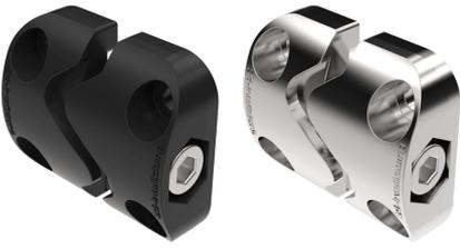
3D-Intellclamp™ para união de quadros ou unidades HVAC. O 3D-Intellclamp™ alinha as partes quando o parafuso central é apertado. Provê uma união firme e com alinhamento perfeito entre as superfícies. Montado com rebites e parafusos.
