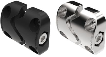
3D-Intellclamp™ pour la connexion de sections ou d'unités. Le 3D-Intellclamp™ alignera les unités séparées dans les axes X, Y et Z au fur et à mesure que le boulon est serré. Fournit une connexion solide avec un alignement parfait des surfaces. Montage avec des rivets ou des vis.
